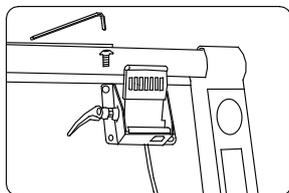
Пропустите трос между связующим механизмом (C) и передней столешницей, установите рычаг на передней столешнице (A) с помощью винта (9) и ключа (1)
