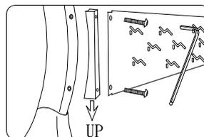
Направьте слово "UP" на накладке (I) к основанию опор и присоедините заднюю панель (J) к обеим опорам (D) с помощью ключа (1) и винтов (13)
