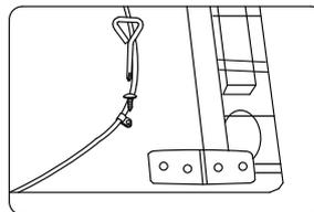
Пропустите трос через хомут (6), закрепите хомут на передней столешнице (A) с помощью винта (5) и отвертки (4)
