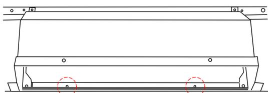
Используя отвертку (4) и винт (10) присоедините алюминиевую направляющую (H) к задней столешнице (B)
