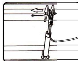
Затяните все винты и извлеките предохранительную шпильку. Внимание: регулировка высоты работает после извлечения шпильки
