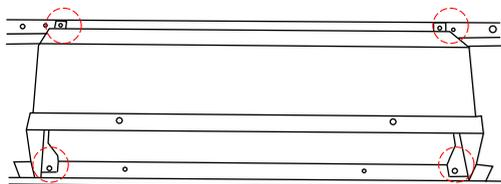
Используя отвертку (4) и винт (10) установите ящик (E) на заднюю столешницу (B).
