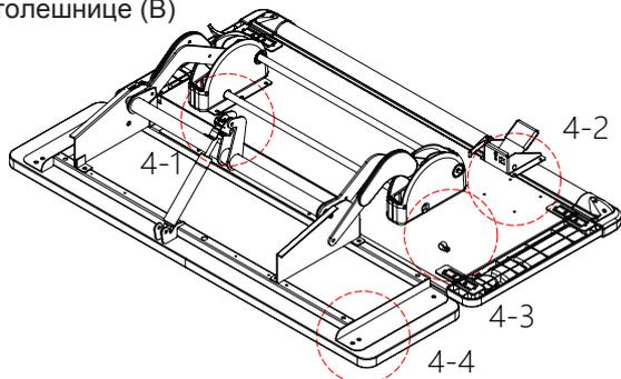
Посредством связующего механизма (C) соедините столешницы (A) и (B), используйте винт (9) и ключ (1)
